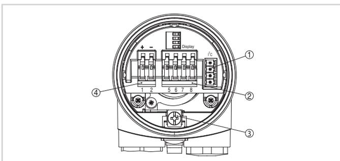
Compartiment électronique et de raccordement boîtier à chambre unique
