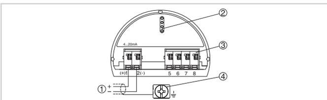
Compartiment électronique et de raccordement boîtier à chambre unique
