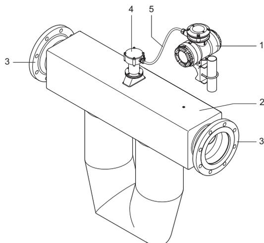
Fig. 4: Configuration du Rotamass type déporté - avec boîte de jonction avec extension
