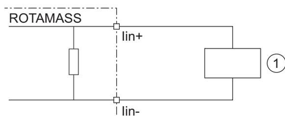
Fig. 28: Raccordement d'un appareil externe avec sortie de courant active
