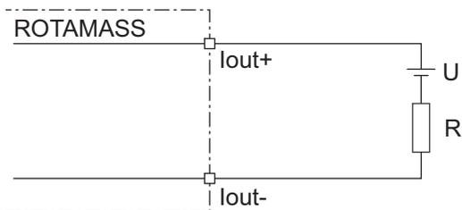
Fig. 26: Raccordement de la sortie de courant passive *I<sub>out</sub>*
