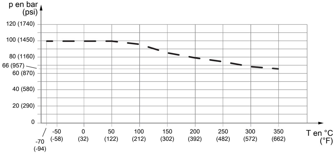
Fig. 11: Pression de service admissible en fonction de la température du fluide, avec bride compatible avec la norme EN 1092-1 PN100
