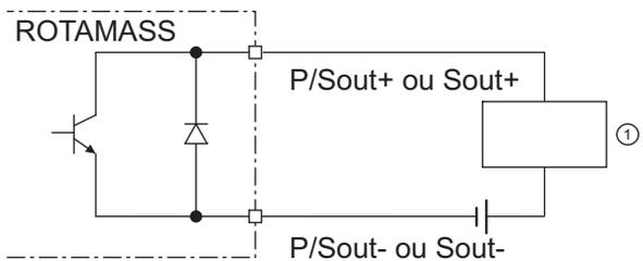
Fig. 36: Raccordement de la sortie d'état passive P/Sout ou Sout
