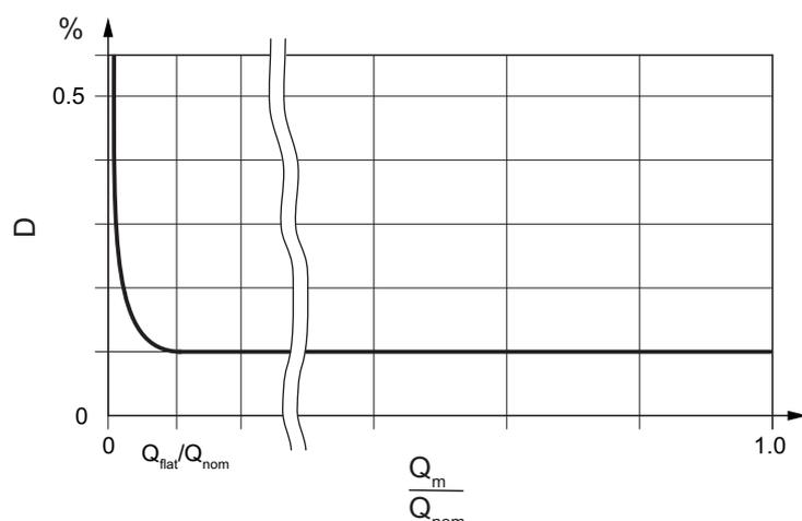
Fig. 5: Dépendance schématique de la précision de mesure du débit massique
