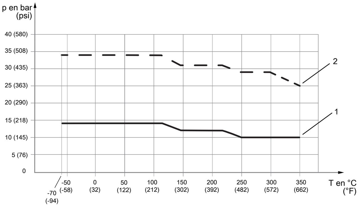
Fig. 12: Pression de service admissible en fonction de la température du fluide
