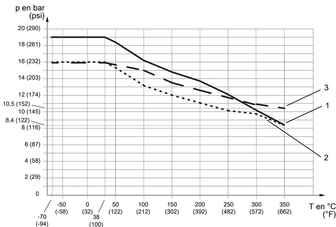
Fig. 8: Pression de service admissible en fonction de la température du raccordement process
