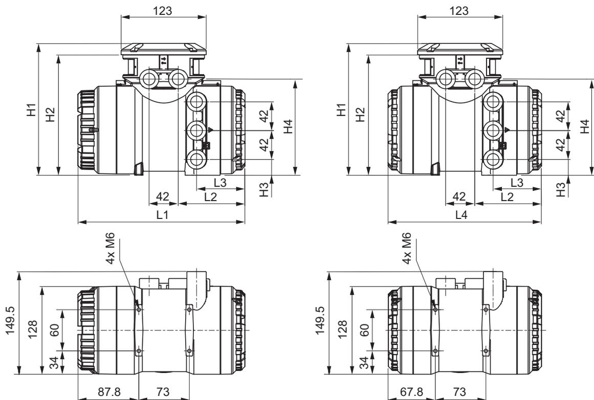
Fig. 22: Dimensions du transmetteur en mm
