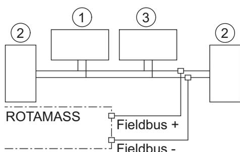
Fig. 41: Raccordement à FOUNDATION Fieldbus
