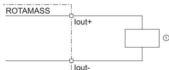
Fig. 24: Raccordement de la sortie de courant active HART *lout*
