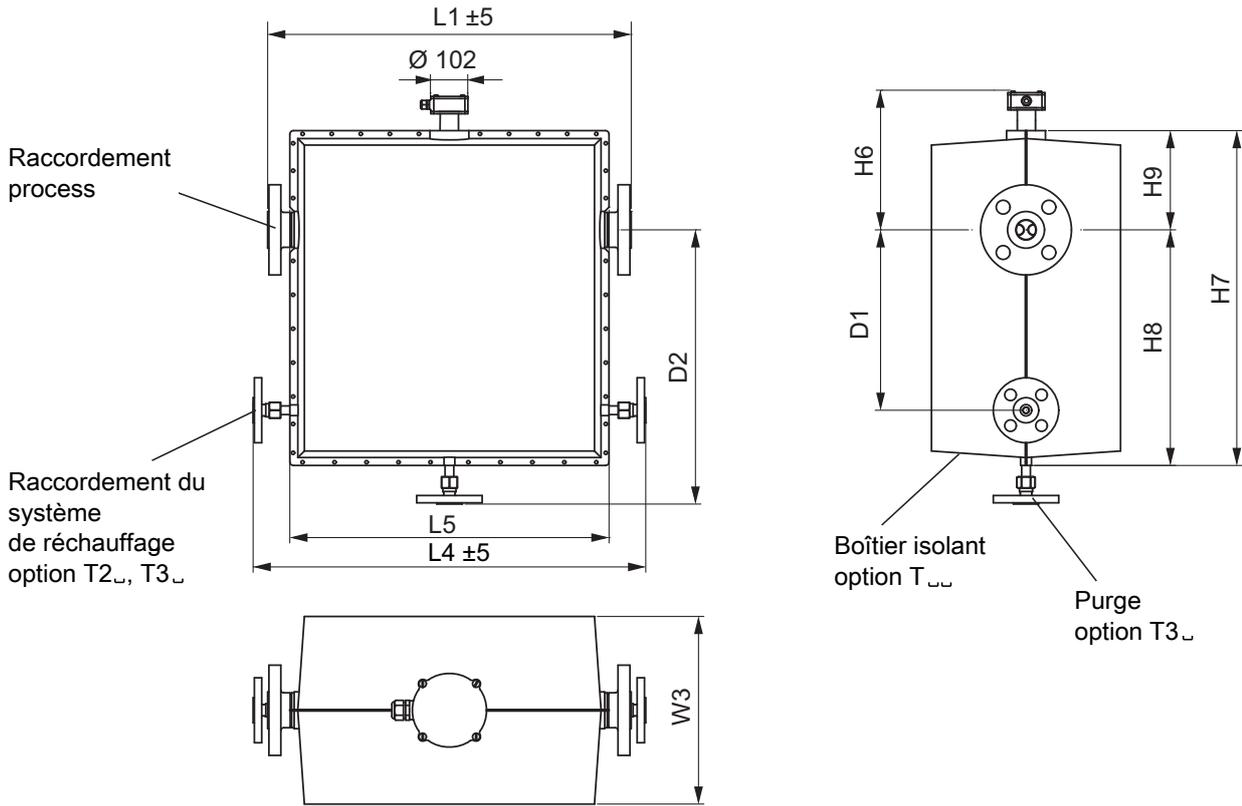
Fig. 21: Dimensions en mm : version avec boîtier d'isolation uniquement pour les modèles Intense 34, 36 et 38
