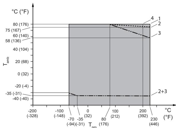
Fig. 15: Température du fluide et température ambiante admissibles, type déporté
