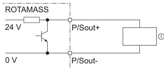
Fig. 31: Sortie d'impulsion active P/Sout avec résistance interne « pull-up »
