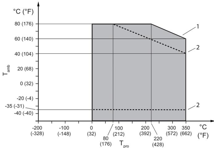
Fig. 16: Température du fluide et température ambiante admissibles, type déporté
