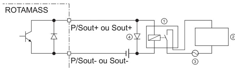
Fig. 37: Raccordement de la sortie d'état passive *P/Sout* ou *Sout* pour la commutation d'une électrovanne
