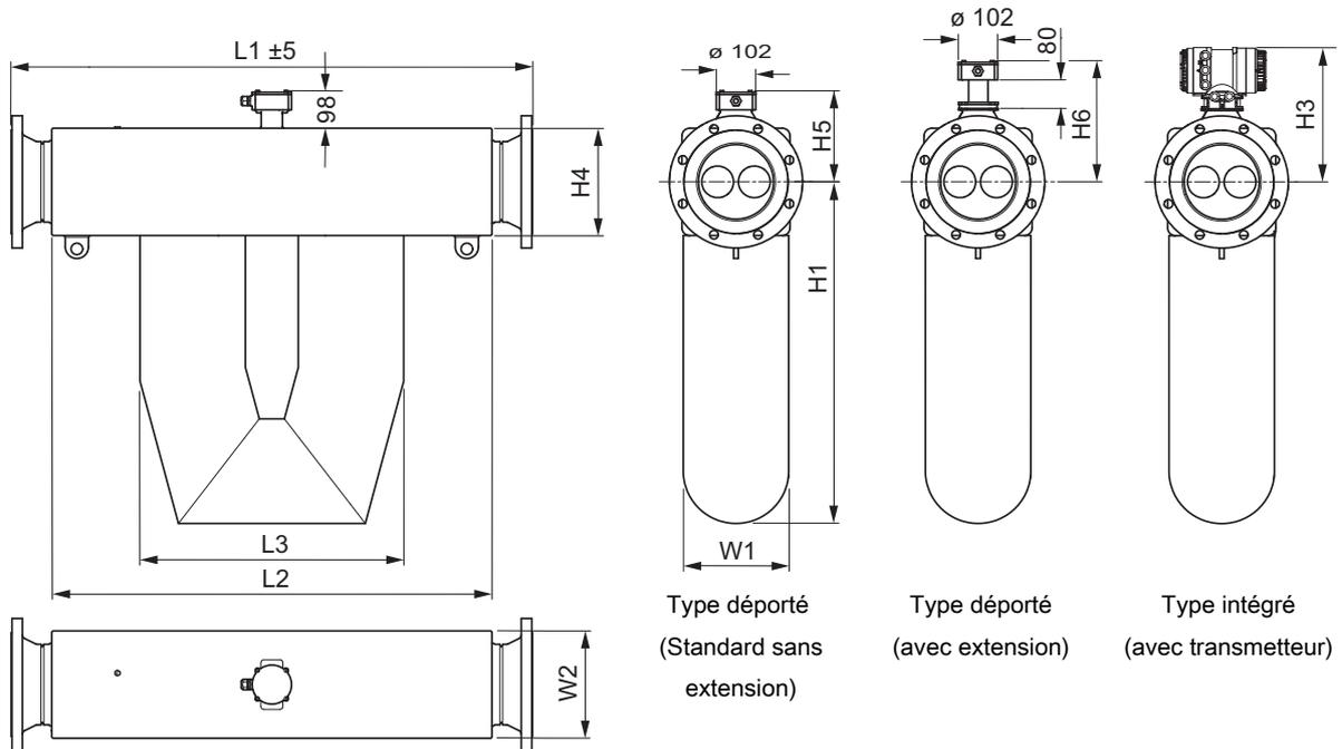
Fig. 19: Dimensions en mm
