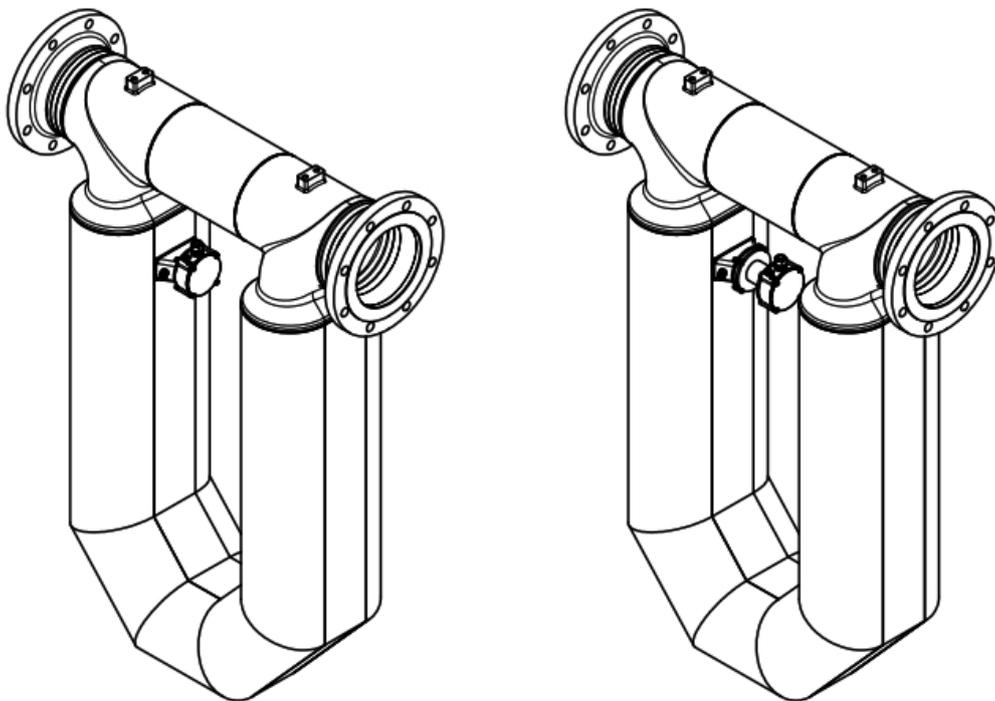
Fig. 18: Boîte de jonction standard et avec extension Giga 2F
