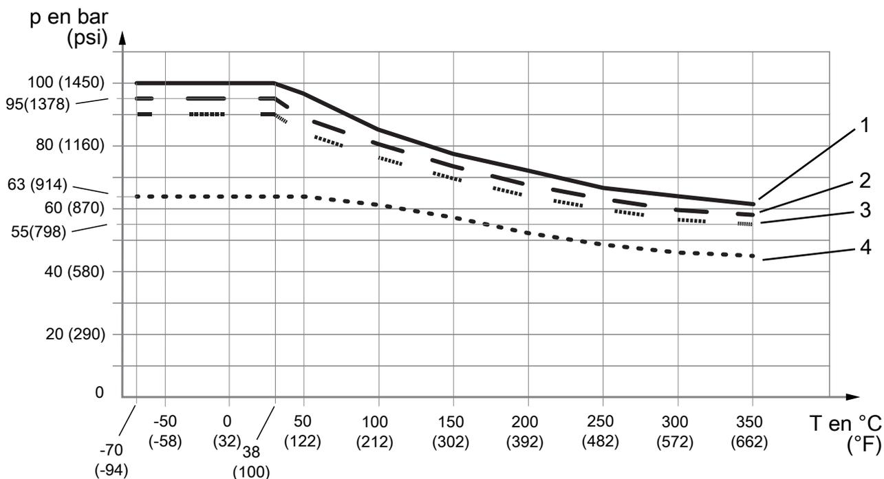
Fig. 10: Pression de service admissible en fonction de la température du raccordement process
