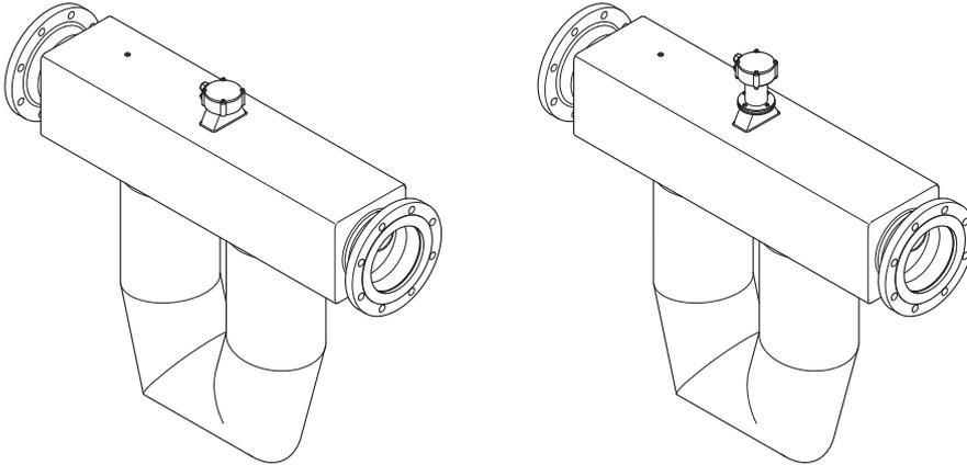
Fig. 17: Boîte de jonction standard et avec extension
