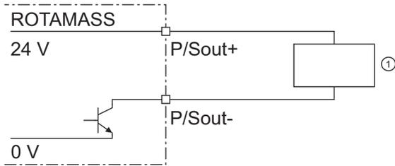
Fig. 34: Raccordement de la sortie d'état active P/Sout
