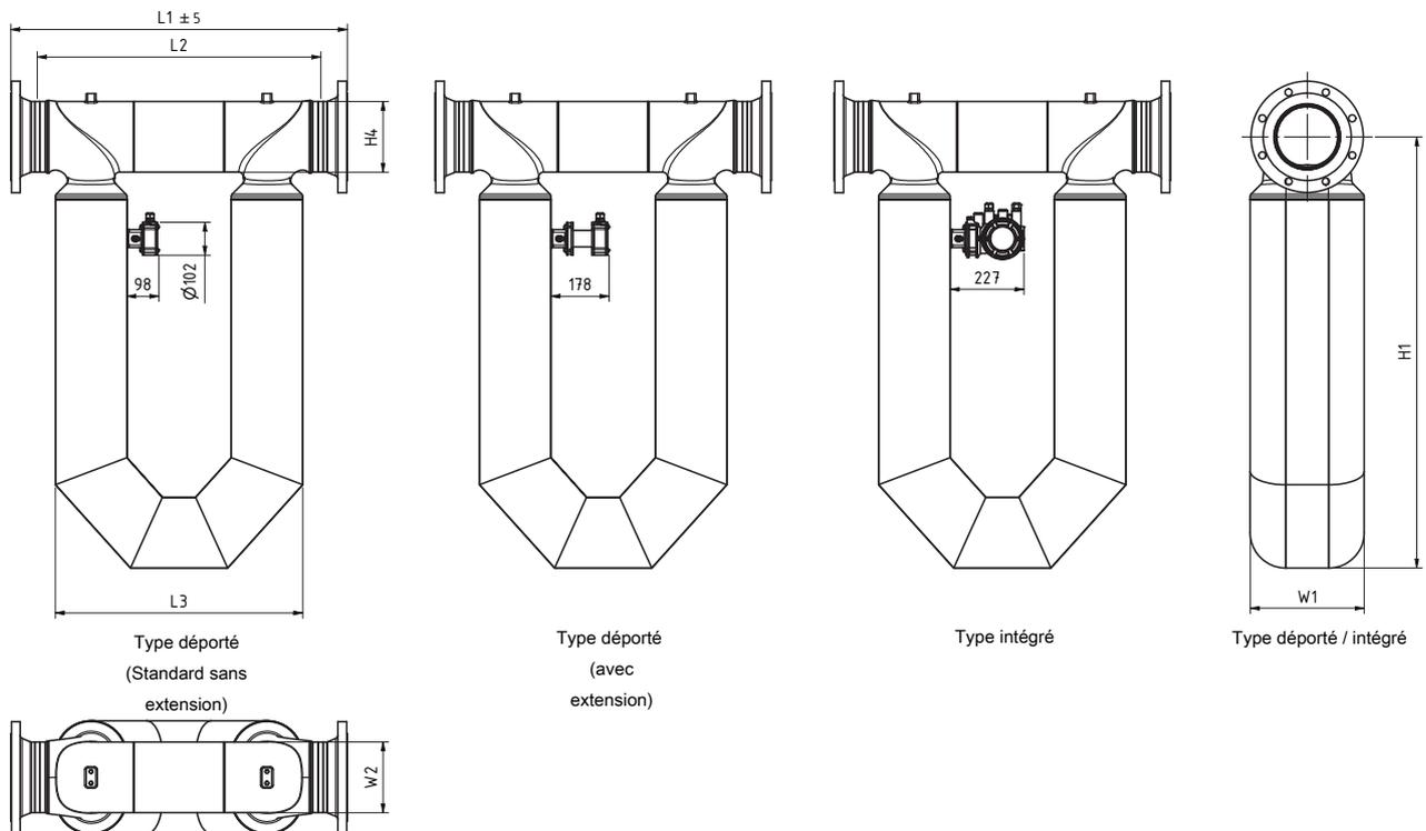
Fig. 20: Dimensions pour Giga 2F en mm
