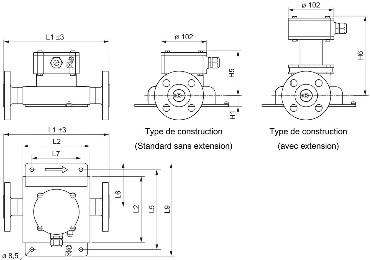
Fig. 21: Dimensions en mm
