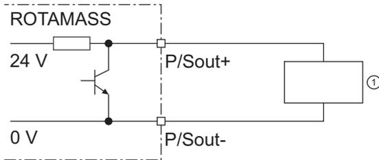
Fig. 33: Sortie d'impulsion active P/Sout avec résistance interne « pull-up »
