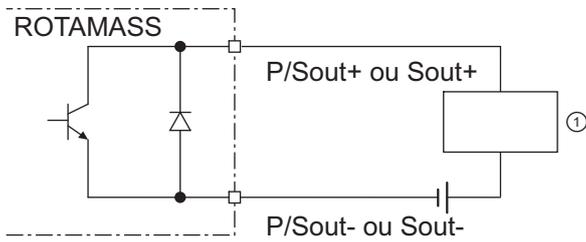
Fig. 38: Raccordement de la sortie d'état passive P/Sout ou Sout
