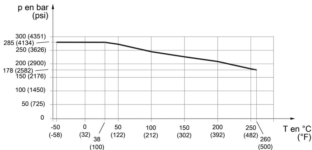
Fig. 15: Pression de service admissible en fonction de la température du fluide
