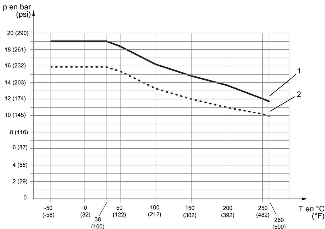
Fig. 7: Pression de service admissible en fonction de la température du raccordement process
