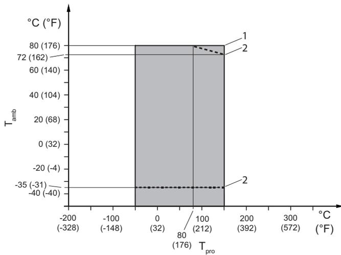
Fig. 17: Température du fluide et température ambiante admissibles, type déporté (sauf pour raccordement process HS4 et HS8)
