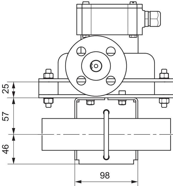
Fig. 23: Dimensions en mm : dispositif de fixation option PD pour Nano
