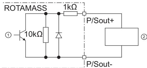
Fig. 40: Raccordement en série de la sortie d'impulsions ou d'état passive avec amplificateur de commutation
