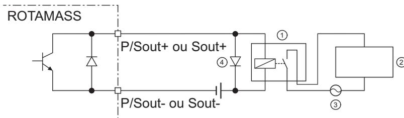
Fig. 39: Raccordement de la sortie d'état passive P/Sout ou Sout pour la commutation d'une électrovanne
