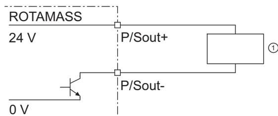
Fig. 36: Raccordement de la sortie d'état active P/Sout
