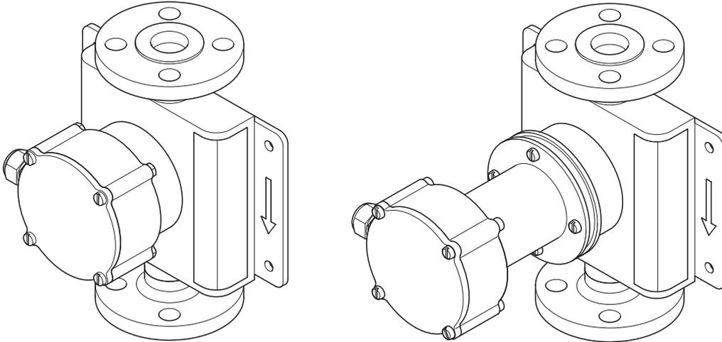
Fig. 20: Capteur avec boîte de jonction standard et avec extension
