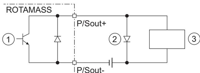
Fig. 35: Raccordement de la sortie d'impulsion passive P/Sout avec compteur électromécanique
