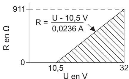
Fig. 27: Résistance de charge maximale en fonction d'une tension d'alimentation externe
