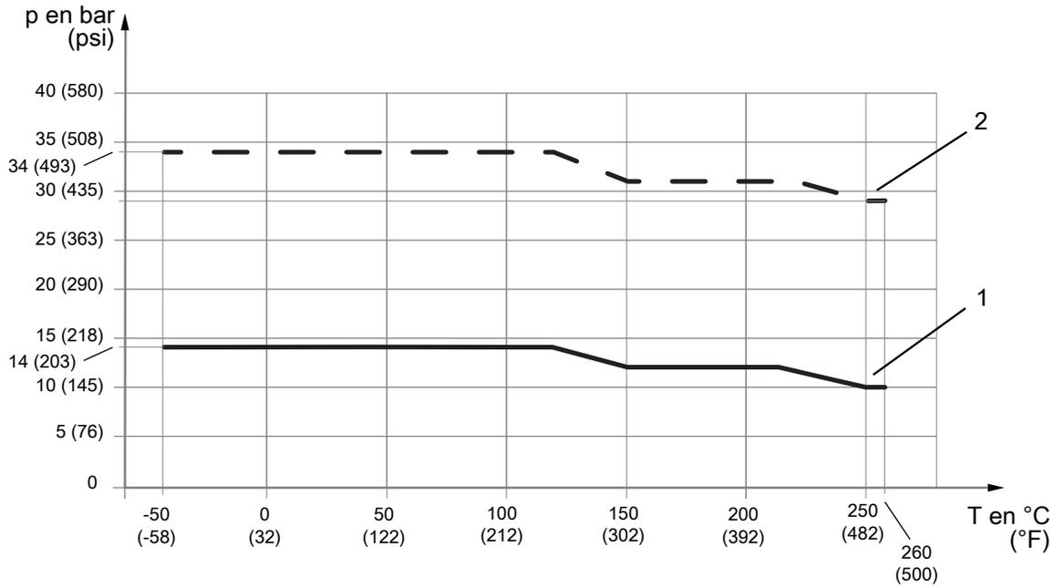
Fig. 12: Pression de service admissible en fonction de la température du raccordement process
