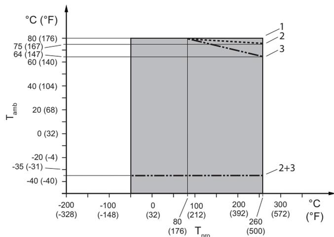
Fig. 19: Température du fluide et température ambiante admissibles
