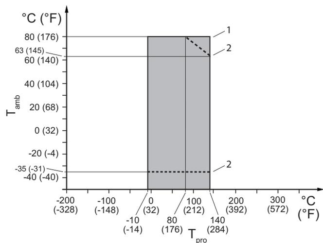
Fig. 18: Température du fluide et température ambiante admissibles, type déporté pour raccordement process HS4 et HS8
