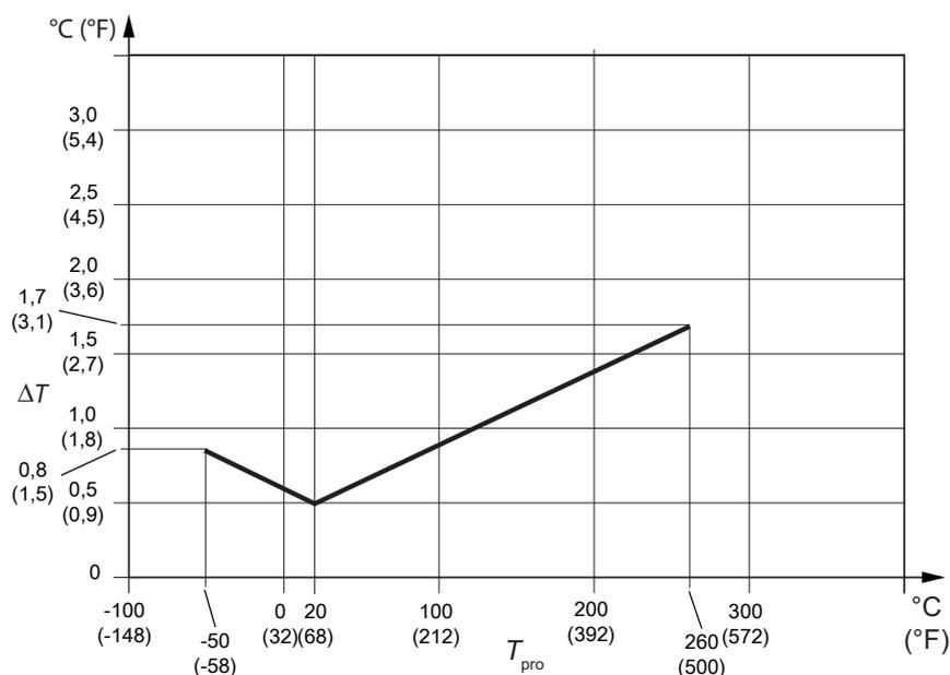
Fig. 5: Précision de température
