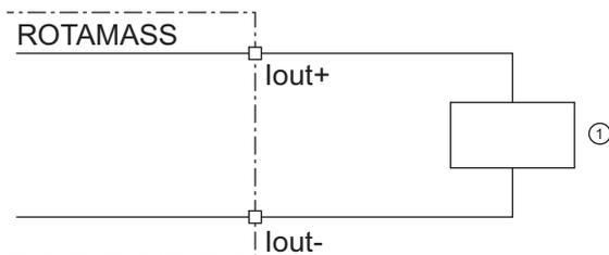
Fig. 26: Raccordement de la sortie de courant active HART *I<sub>out</sub>*
