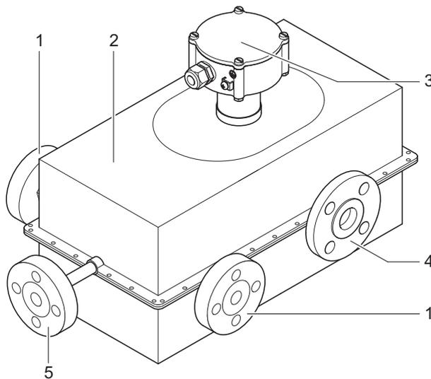
Fig. 16: Configuration du Rotamass avec isolation et circuit de réchauffage
