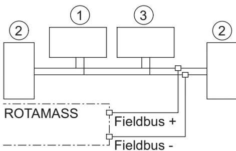
Fig. 43: Raccordement à FOUNDATION Fieldbus
