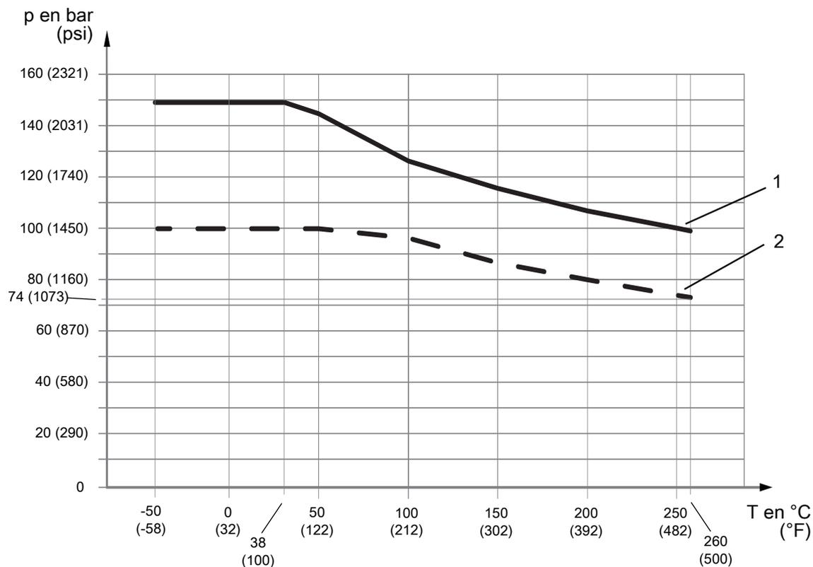
Fig. 10: Pression de service admissible en fonction de la température du raccordement process
