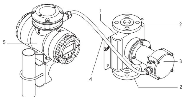
Fig. 3: Configuration du Rotamass type déporté - avec boîte de jonction avec extension
