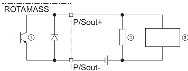
Fig. 34: Raccordement de sortie d'impulsion passive P/Sout avec compteur électronique
