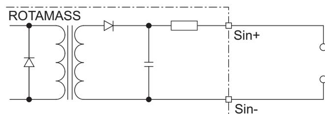
Fig. 41: Raccordement de l'entrée d'état
