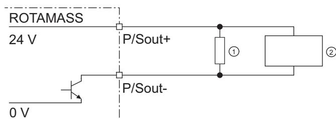
Fig. 31: Raccordement de la sortie d'impulsion active P/Sout
