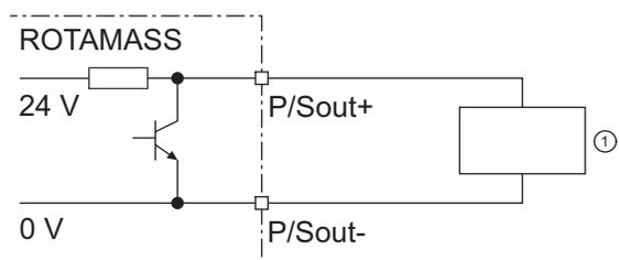
Fig. 37: Sortie d'état active P/Sout avec résistance interne pull-up
