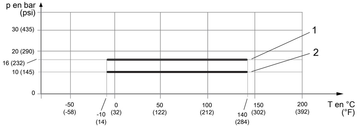
Fig. 13: Pression de service admissible en fonction de la température du fluide
