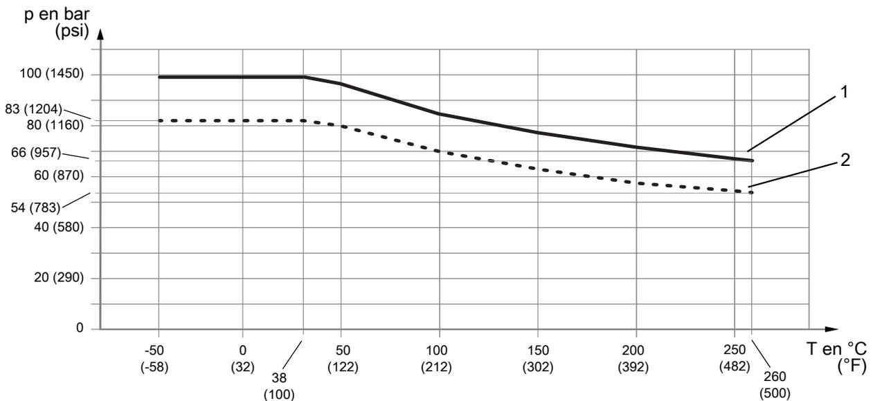
Fig. 9: Pression de service admissible en fonction de la température du raccordement process
