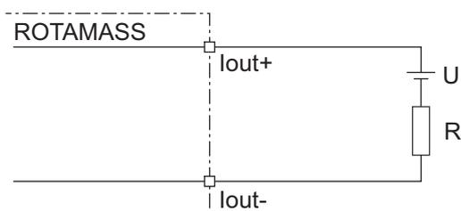
Fig. 28: Raccordement de la sortie de courant passive *I<sub>out</sub>*
