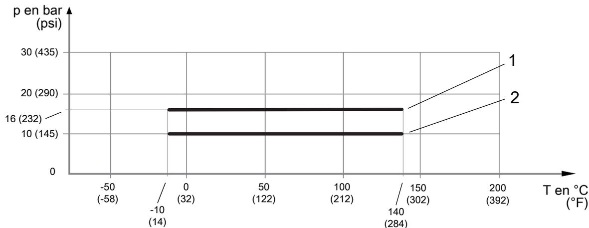
Fig. 14: Pression de service admissible en fonction de la température du fluide
