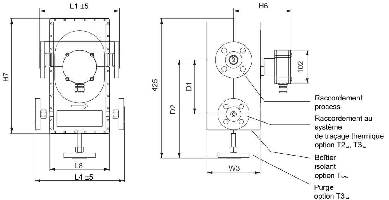
Fig. 22: Dimensions en mm : version avec boîtier d'isolation uniquement pour les modèles Intense 34, 36 et 38
