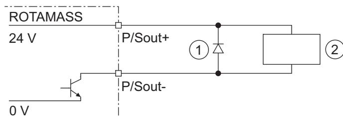
Fig. 32: Raccordement de sortie d'impulsion active P/Sout avec compteur électromécanique
