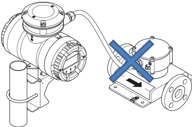
Fig. 6: Position de montage à éviter : Débitmètre en position latérale
