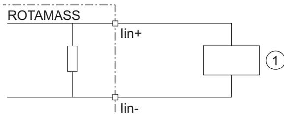
Fig. 30: Raccordement d'un appareil externe avec sortie de courant active
