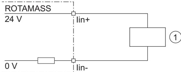
Fig. 29: Raccordement d'un appareil externe avec sortie de courant passive
