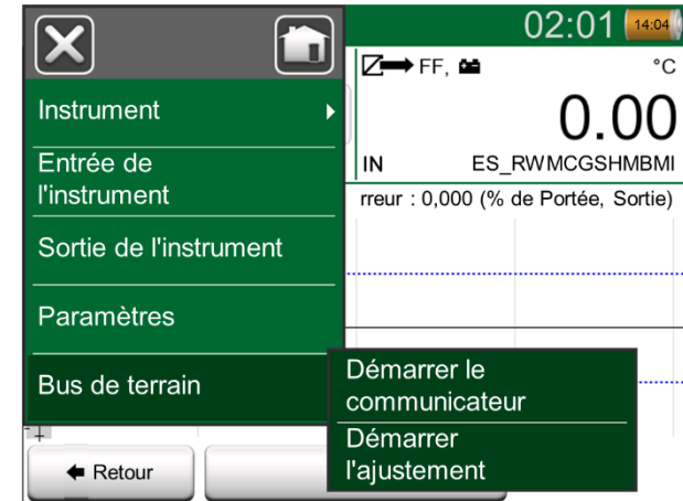
Menu du Mode étalonnage lorsque l'étalonnage d'un instrument de bus de terrain est en cours.
