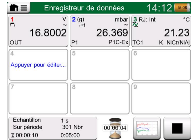
Compte à rebours du délai
