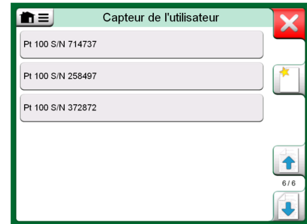
Un exemple de liste de capteurs RTD personnalisés saisie dans le MC6.
