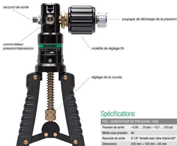
**La PGC** est une pompe à main pneumatique destinée à générer de la pression et du vide. Grâce au commutateur vous pouvez rapidement choisir entre génération de pression ou de vide. Le réglage fin permet d'ajuster précisément la pression générée.
